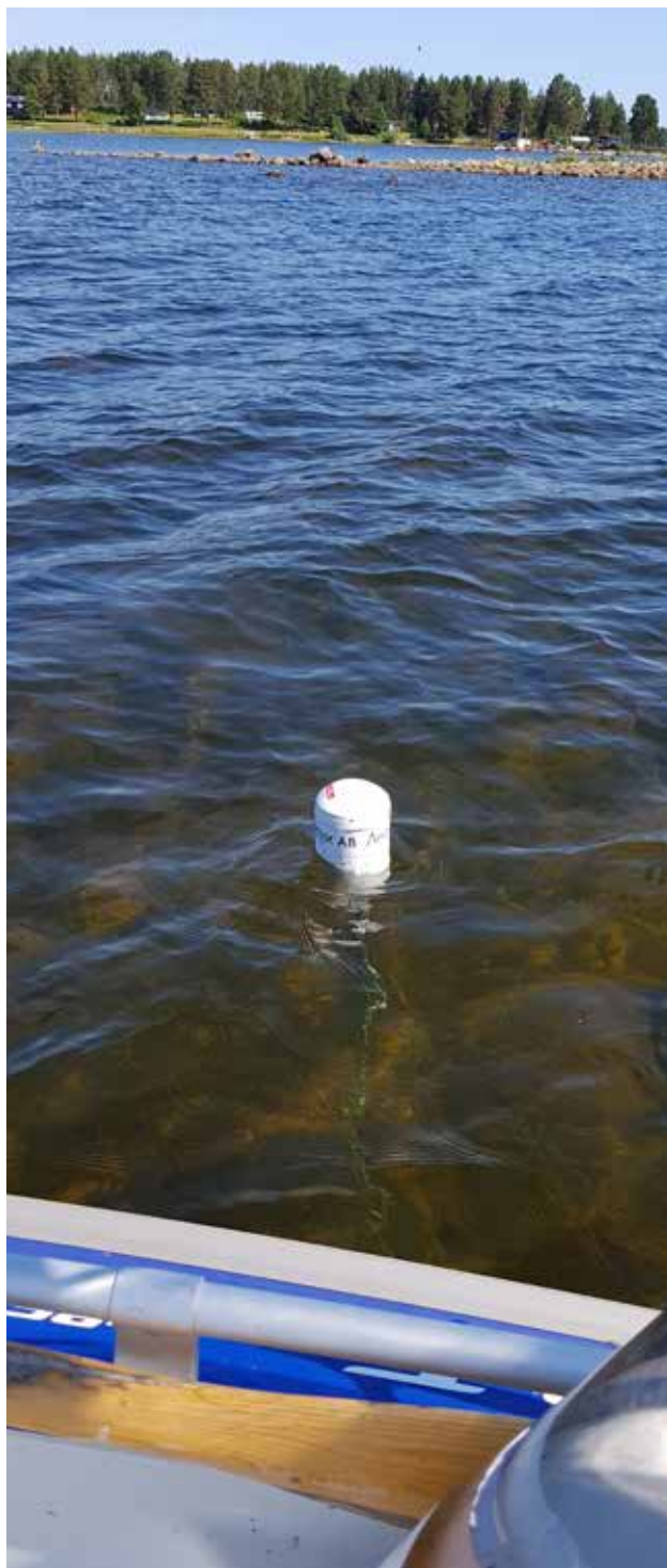
På bojen finns en sensor som mäter temperatur.
